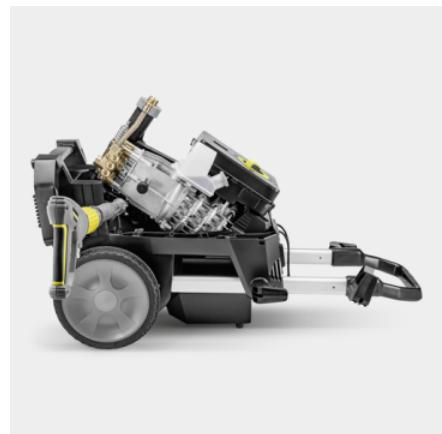
**Langsam laufender 4-poliger Motor mit Wasser- und Luftkühlung, robuste Pumpe mit Edelstahlkolben und Messing-Zylinderkopf**
